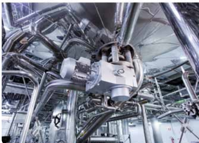
Každý pohon bol prispôsobený na individuálne požiadavky jednotlivých aplikácií. Na obrázkoch sú kuželové elektroprevodkové motory pre vystieracie kade
