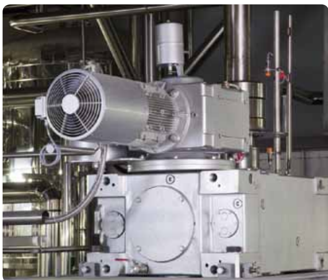
Procesy v sciedzacej nádrži má na starosti jeden pohon s krútiacim momentom 96 000 Nm
